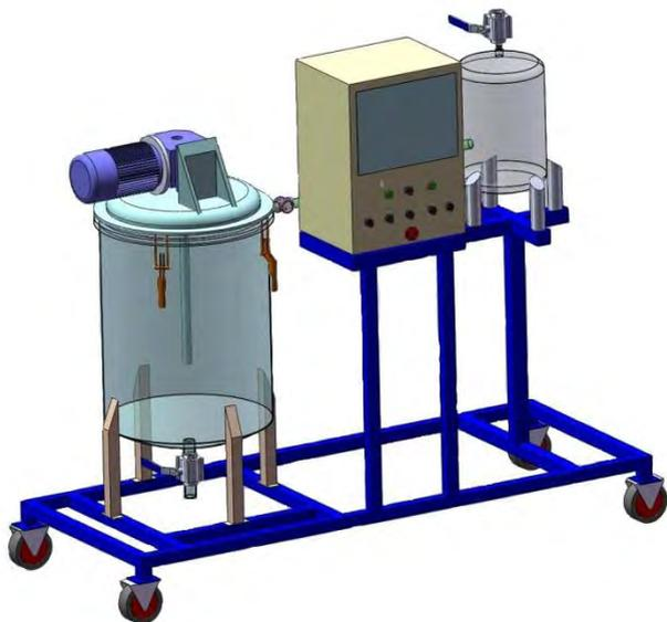
Foto 7. Esquema del digestor propuesto
