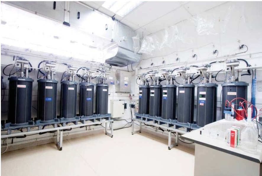
Digestores piloto en ainia centro tecnológico.
